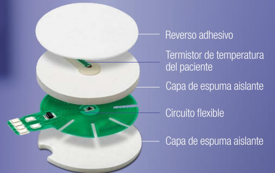
A diferencia de los sensores pasivos de temperatura de la superficie de la piel, el sensor de un solo uso del sistema SpotOn consiste en un aislante térmico adyacente a la piel y cubierto por un circuito flexible. Una vez que el circuito flexible se conecta a la unidad de control de SpotOn, regula activamente su temperatura para crear una zona de aislamiento perfecto: una situación en la que se elimina la pérdida de calor hacia el exterior.
