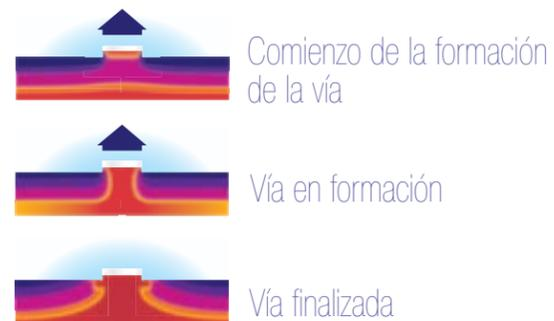
Después de varios minutos, la vía isotérmica se abre debajo del sensor, y esto permite que la temperatura central suba hacia la superficie.
